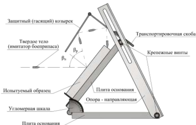
Рис. 1. Схема экспериментальной установки для испытания различных преград при моделировании процесса рикошета
