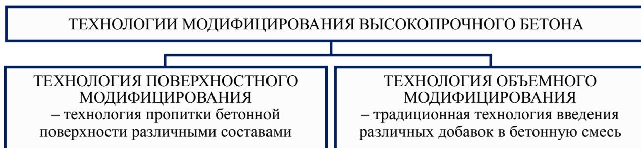
Рис. 3. Технологии модифицирования высокопрочных бетонов зольсодержащими растворами
