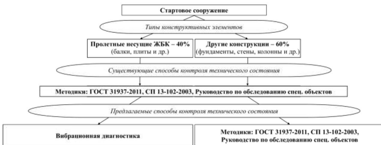
Рис. 2. Анализ возможных способов контроля технического состояния несущих конструкций стартовых сооружений
